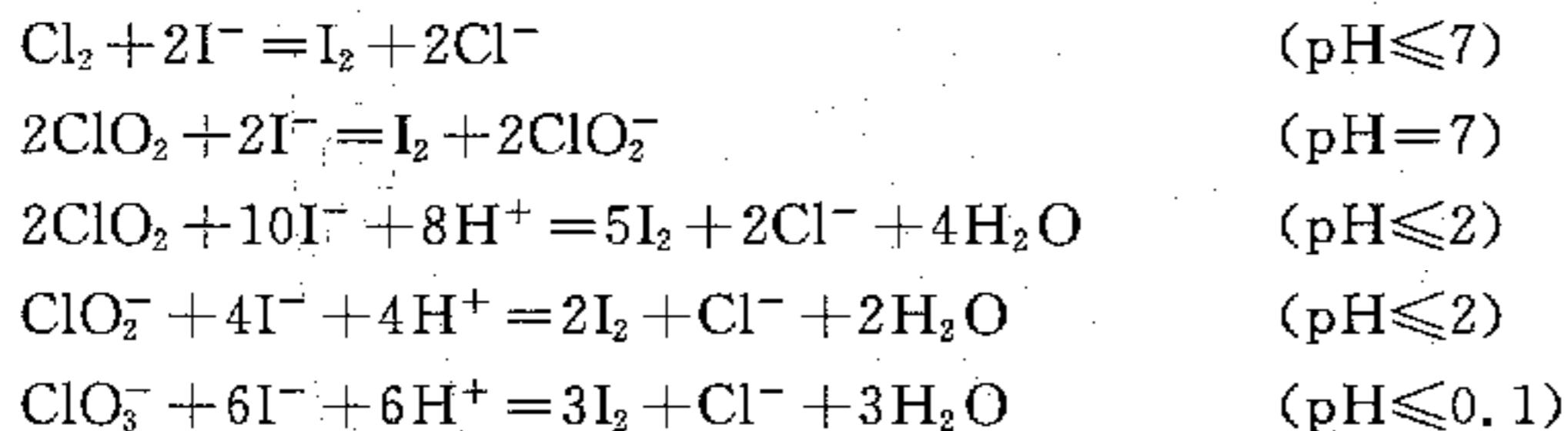
然后用硫代硫酸钠作滴定剂,以淀粉溶液作指示剂,分步滴定游离出的碘,算出各种氧化性物质的含量。
